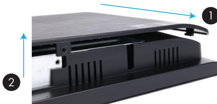
Снимите защитный экран, открутив 5 винтов.
