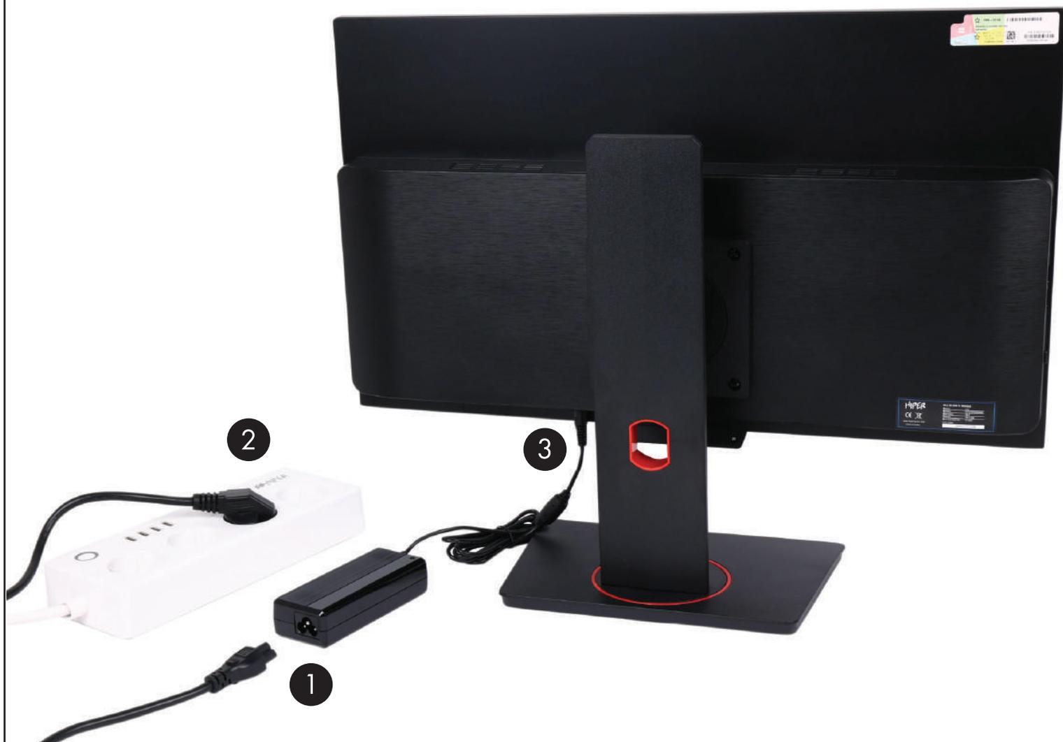
Подсоедините один конец кабеля питания к адаптеру переменного тока (1), а другой конец — к заземлённой электрической розетке (2), затем подсоедините адаптер переменного тока к разъёму питания компьютера (3).
