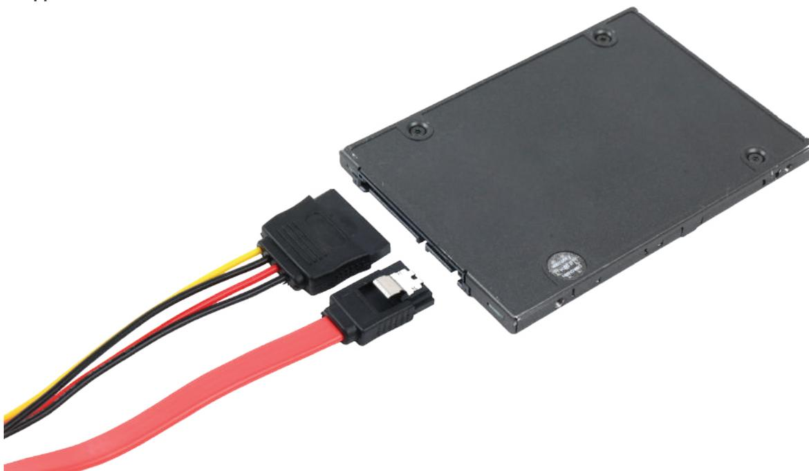
Прикрутите накопитель 2,5" двумя винтами на крепеж на корпусе.
