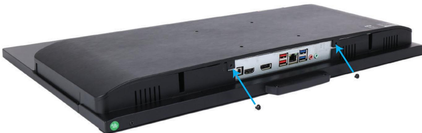
При необходимости повесить моноблок на крепления VESA, открутите 4 винта и снимите подставку.
