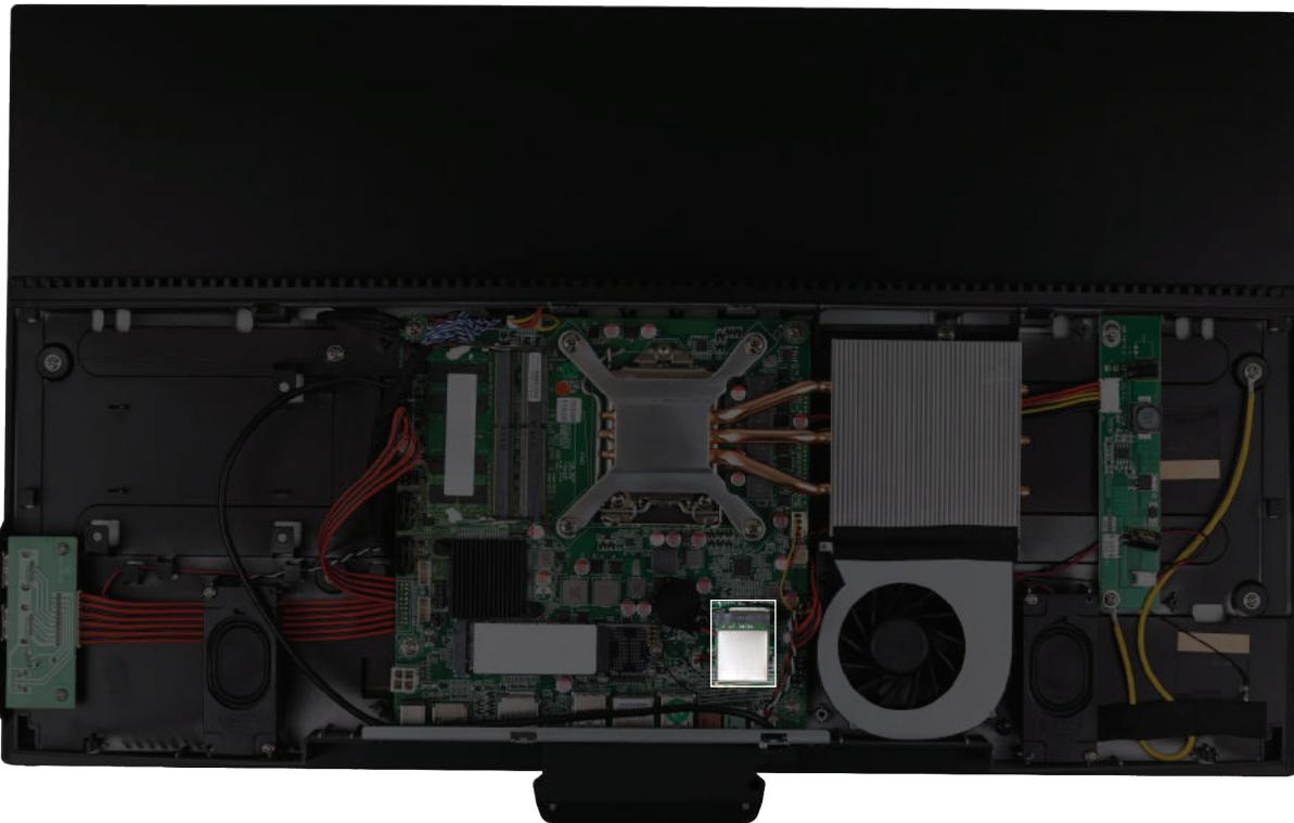
Отсоедините антенные кабели (1) от модуля беспроводной сети. Выверните винт (2), крепящий модуль беспроводной сети к системной плате, а затем возьмите модуль за боковые стороны и извлеките из гнезда (3).
