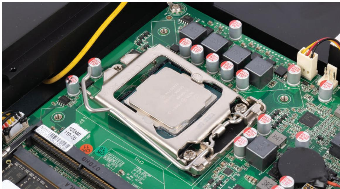
Нанесите термопасту и установите на место систему охлаждения.
