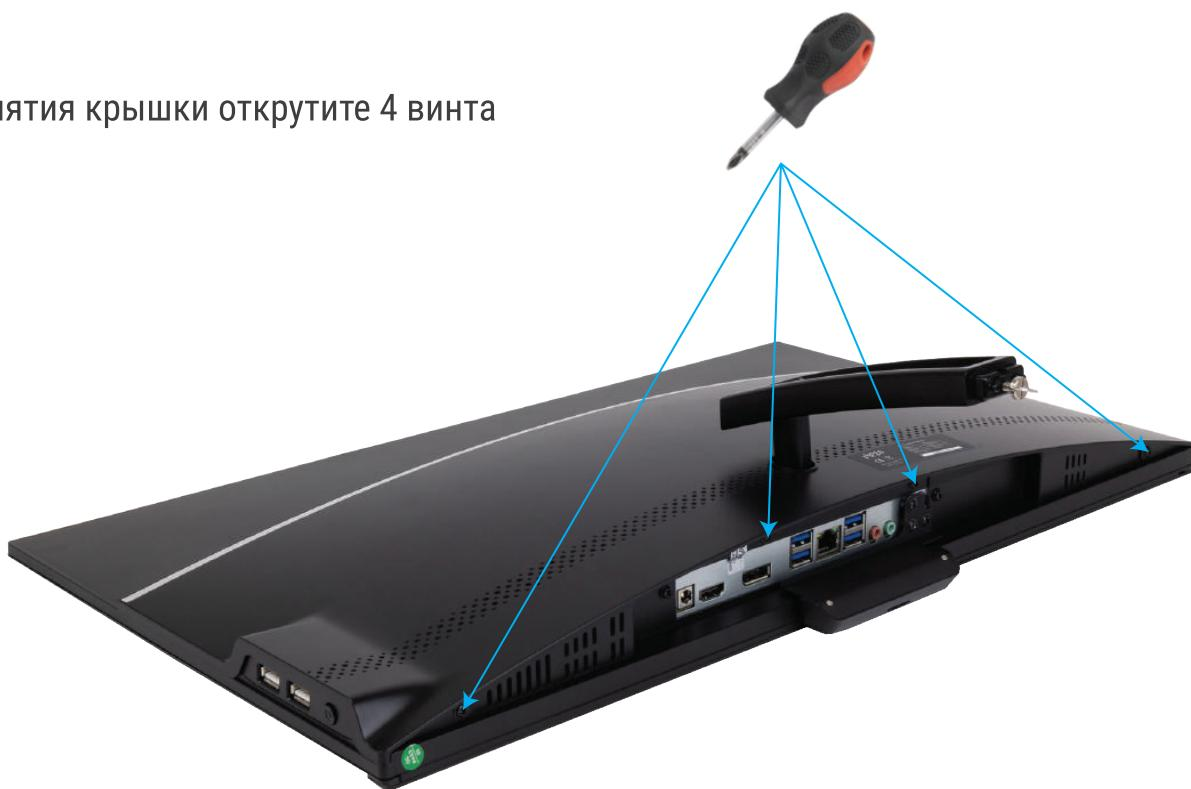
Затем сдвиньте крышку на себя (1) и поднимите её вверх (2)
