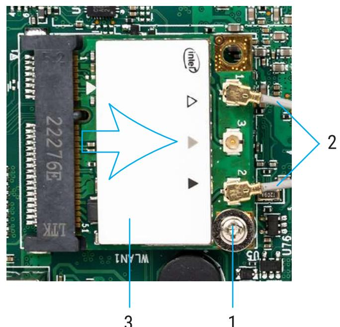
3) Вставьте до упора новый модуль беспроводной сети в гнездо (1) на системной плате под углом примерно 30°, а затем зафиксируйте его с помощью прилагаемого винта (2). Затем подсоедините антенный кабель (3) к разъему на модуле.
