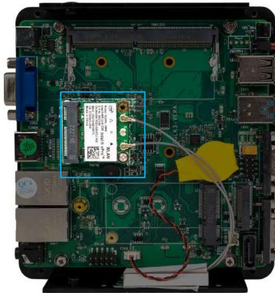
2) Отсоедините антенные кабели (1) от модуля беспроводной сети. Выверните винт (2), крепящий модуль беспроводной сети к системной плате, а затем возьмите модуль за боковые стороны и извлеките из гнезда (3).
