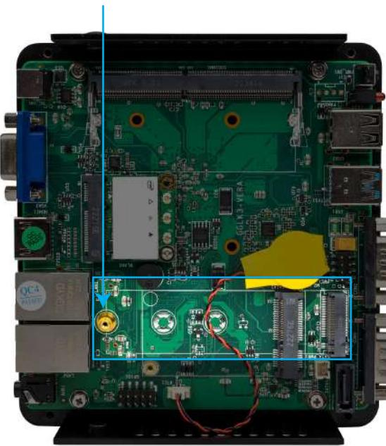
2) Вставьте разъём твердотельного накопителя в гнездо (1) на системной плате под углом примерно 30° и закрепите его с помощью винта (2).
