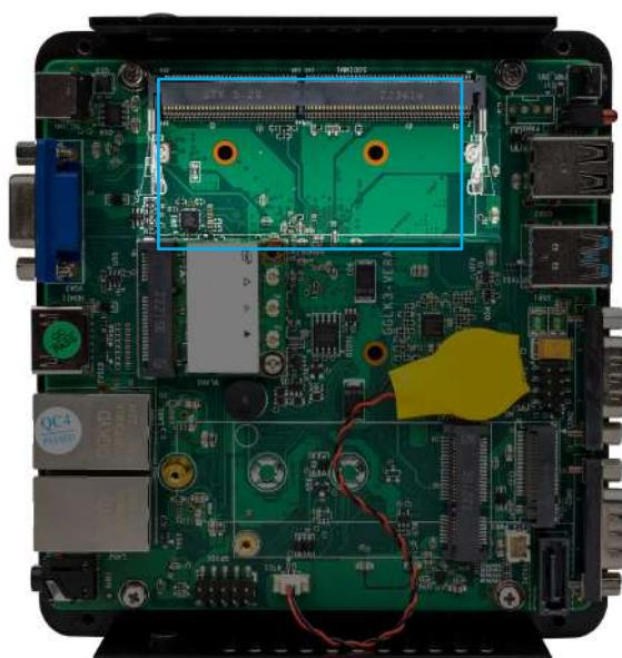
1) Чтобы установить модуль памяти, совместите вырез (1) на новом модуле памяти с выступом в гнезде для модуля памяти. Вставьте модуль памяти в гнездо (2) под углом примерно 30°, затем нажмите на модуль памяти (3) так, чтобы фиксаторы встали на место.
