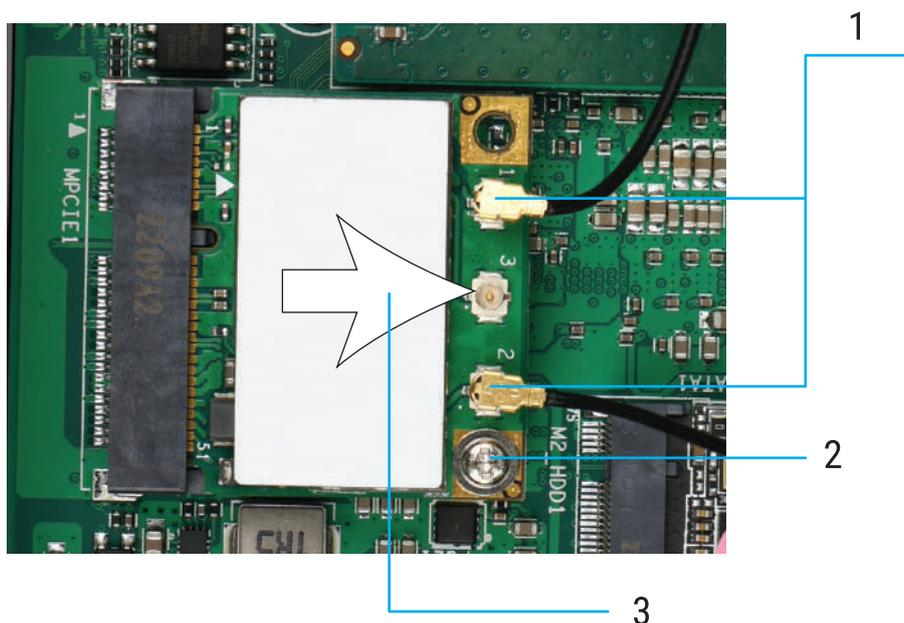
Вставьте до упора новый модуль беспроводной сети в гнездо (1) на системной плате под углом примерно 30°, а затем зафиксируйте его с помощью прилагаемого винта (2). Затем подсоедините антенный кабель (3) к разъему на модуле.
