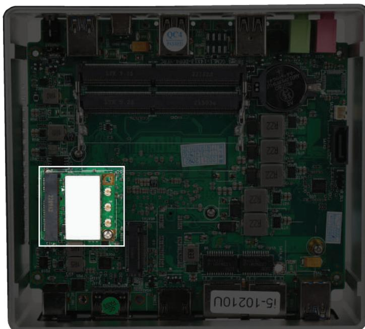
Отсоедините антенные кабели (1) от модуля беспроводной сети. Выверните винт (2), крепящий модуль беспроводной сети к системной плате, а затем возьмите модуль за боковые стороны и извлеките из гнезда (3)
