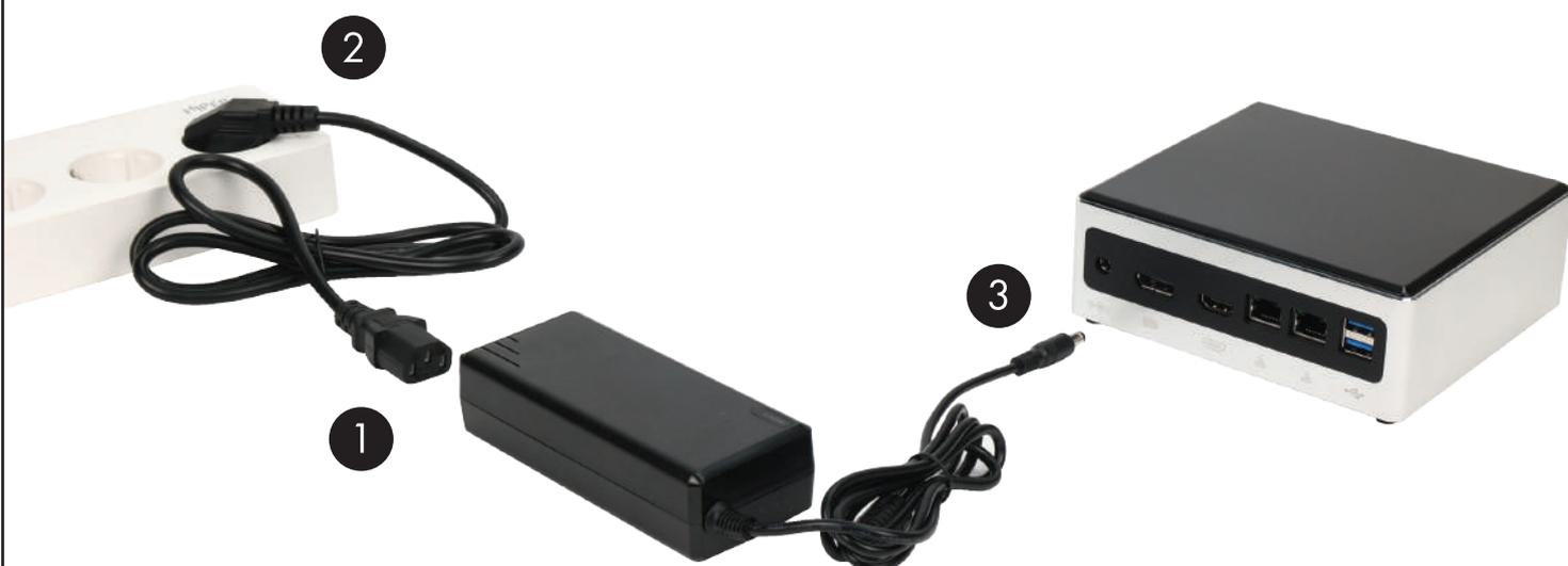
Подсоедините один конец кабеля питания к адаптеру переменного тока (1), а другой конец – к заземлённой электрической розетке (2), затем подсоедините адаптер переменного тока к разъёму питания компьютера (3).
