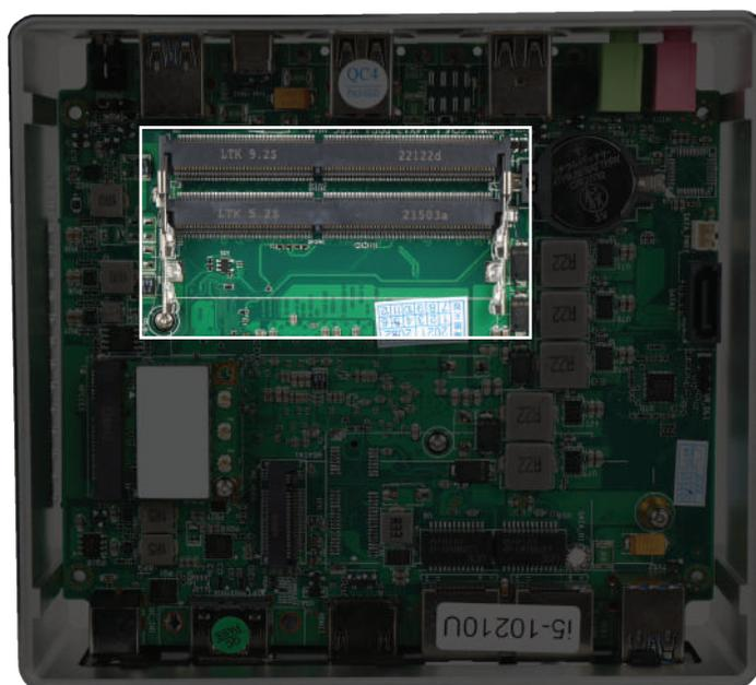
1) Чтобы установить модуль памяти, совместите вырез (1) на новом модуле памяти с выступом в гнезде для модуля памяти. Вставьте модуль памяти в гнездо (2) под углом примерно 30°, затем нажмите на модуль памяти (3) так, чтобы фиксаторы встали на место.
