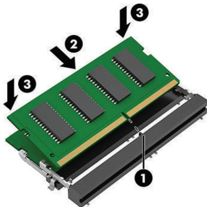
2) Чтобы извлечь модуль памяти, отведите в стороны две защелки (1) по бокам модуля памяти, а затем извлеките модуль памяти (2) из гнезда.
