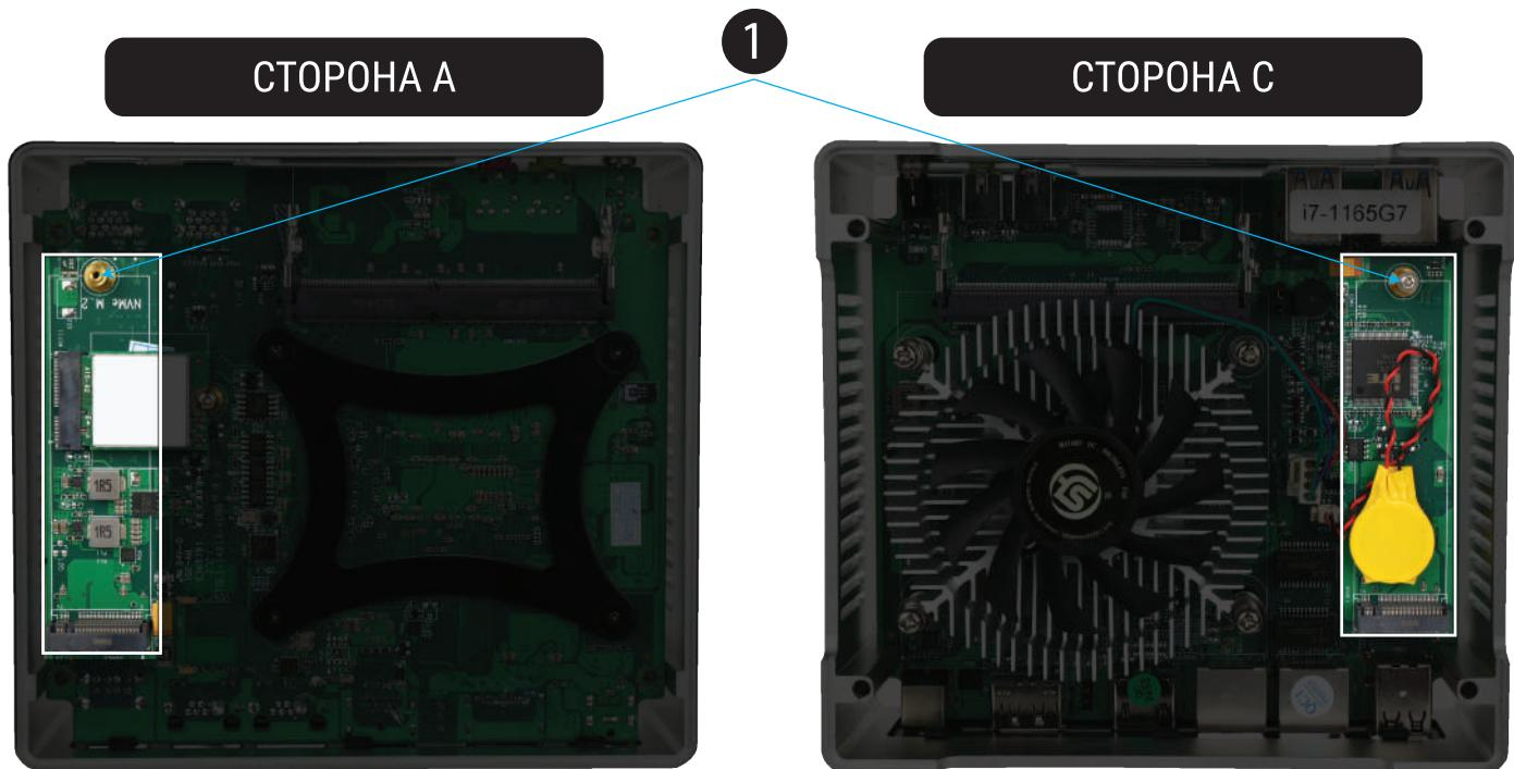
Вставьте разъём нового накопителя в гнездо на системной плате под углом примерно 30° и закрепите его с помощью винта.
