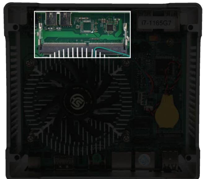
1) Чтобы установить модуль памяти, совместите вырез (1) на новом модуле памяти с выступом в гнезде для модуля памяти. Вставьте модуль памяти в гнездо (2) под углом примерно 30°, затем нажмите на модуль памяти (3) так, чтобы фиксаторы встали на место.
