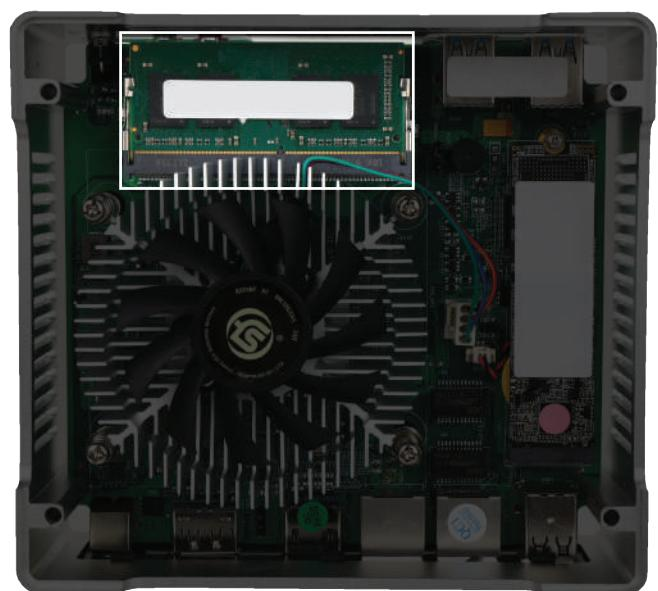
2) Чтобы извлечь модуль памяти, отведите в стороны две защелки (1) по бокам модуля памяти, а затем извлеките модуль памяти (2) из гнезда.
