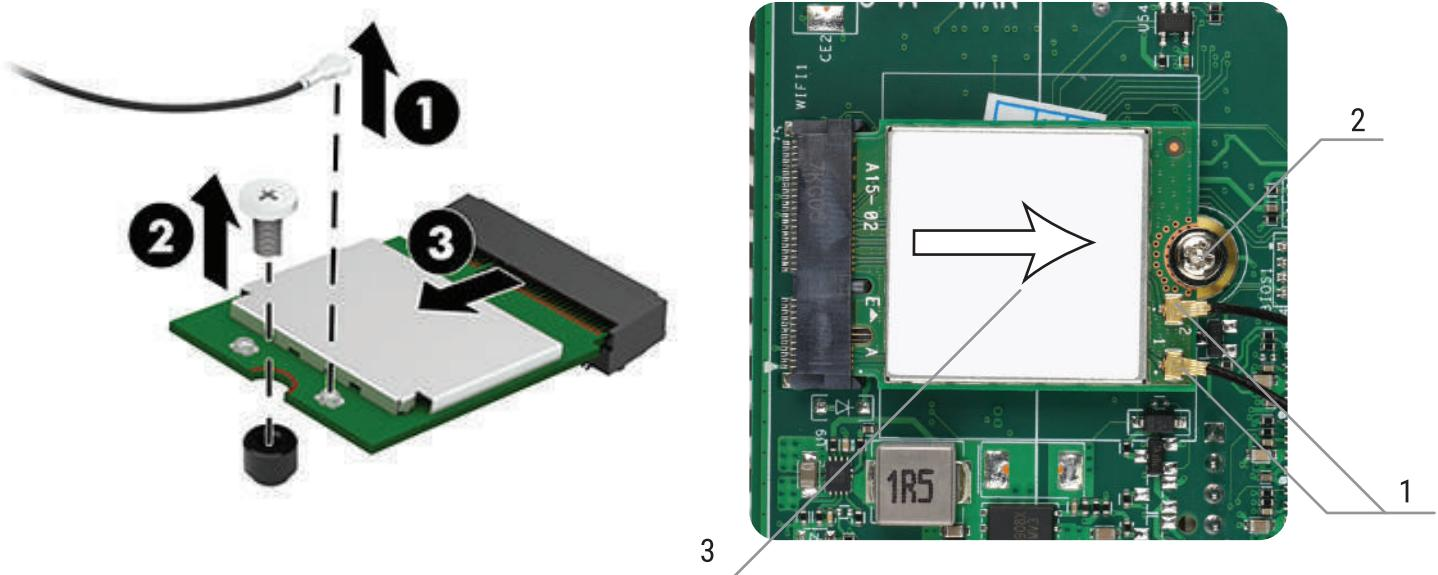
Вставьте до упора новый модуль беспроводной сети в гнездо (1) на системной плате под углом примерно 30°, а затем зафиксируйте его с помощью прилагаемого винта (2). Затем подсоедините antennные кабели (3) к разъему на модуле.
