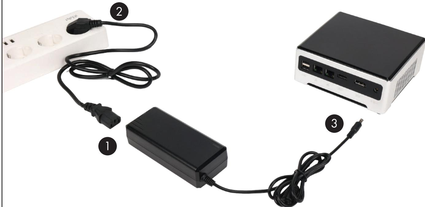
Подсоедините один конец кабеля питания к адаптеру переменного тока (1), а другой конец – к заземлённой электрической розетке (2), затем подсоедините адаптер переменного тока к разъёму питания неттопа (3).
