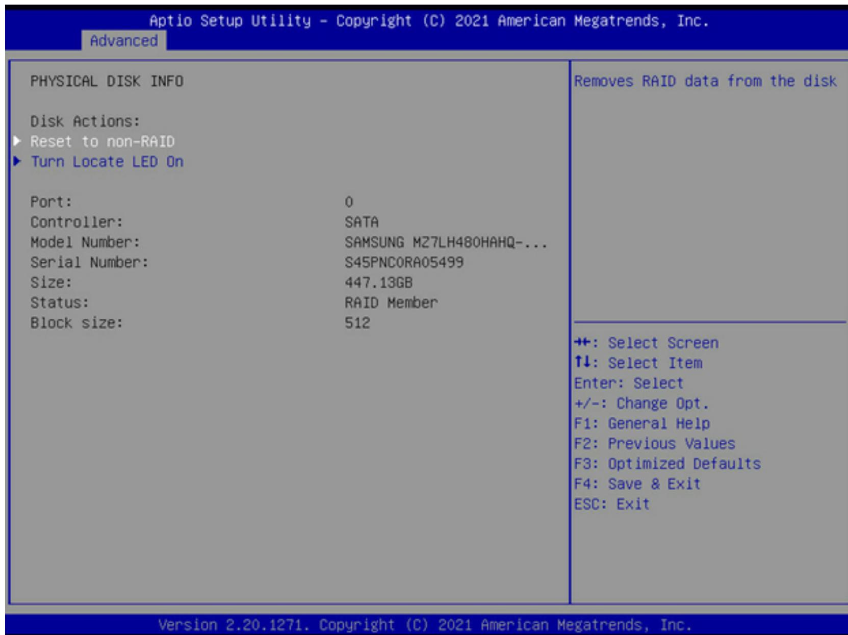
11. Определить, в какой корзине установлен выбранный накопитель посредством включения мигающей индикации.
