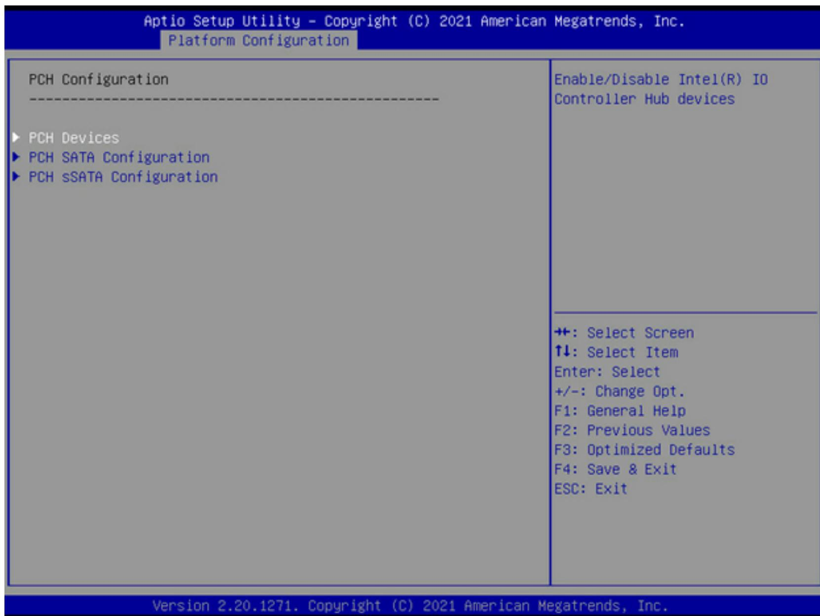
2. В зависимости от того, какого типа накопитель и RAID контроллер используются в платформе, необходимо выбрать один из вариантов настройки PCH. В данном случае это «PCH SATA Configuration».
